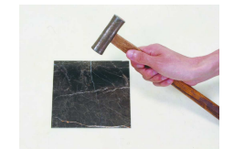
ハンマーでマールシートを叩く (板厚3mm)
